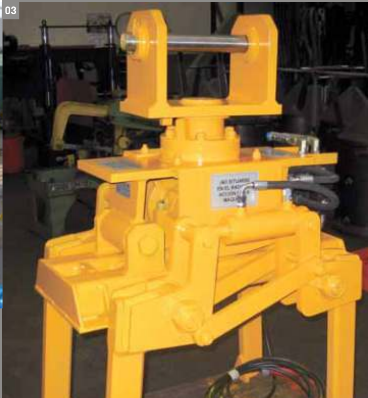
02 Специальный подъемник для лопастей ветрогенераторамассой 3,5 тонны.
