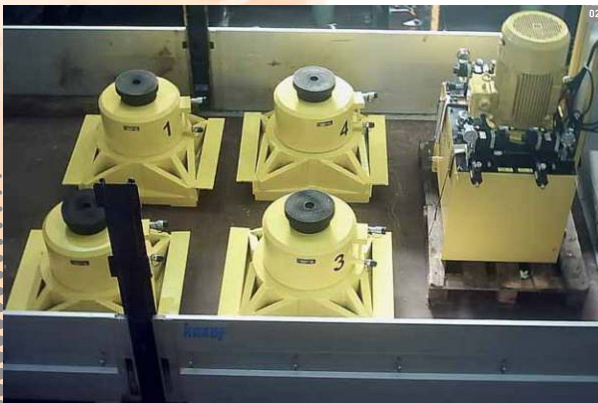
02 500-тонные цилиндры с гидравлической системой питания.
