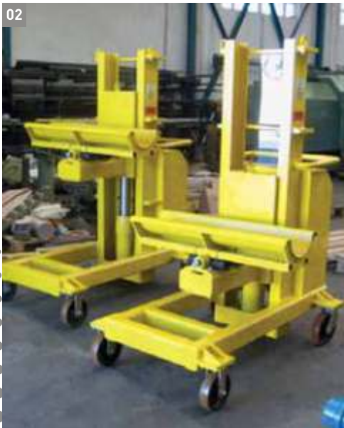
02 Специальный подъемник для лопастей ветрогенераторамассой 3,5 тонны.
